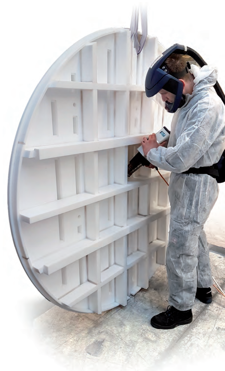
Stoffaustauschboden mit aufgeschweißter Rippenkonstruktion zur Stabilisierung. „Boden aus 30 mm starker Platte“
